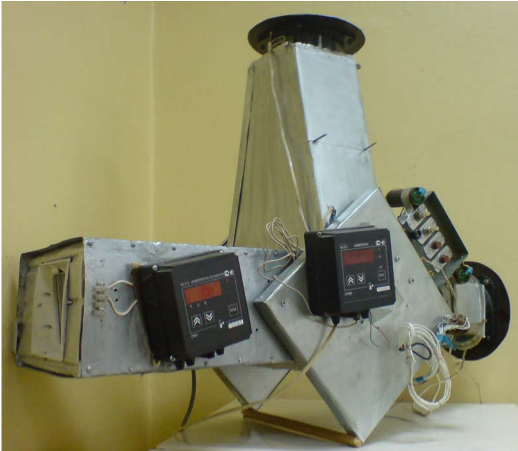
Рис. 6. Лабораторная вентиляционная установка с перекрестноточным полимерным теплообменником (фотография)
