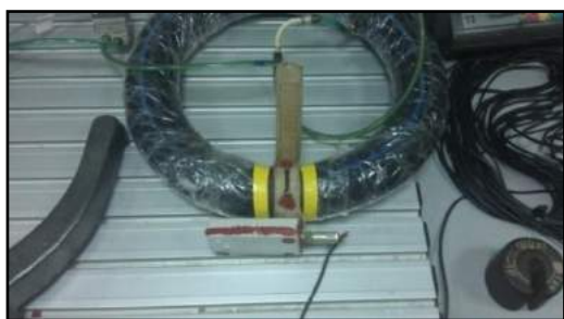
Рисунок 4 – Модель хвоста коровы с закрепленным прототипом (слева) и стенд для проведения исследований (справа)
